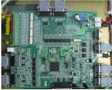
شکل ۳: برد مدار چاپی کنترل کننده ی کانورتر ۱۰۰ کیلووات
